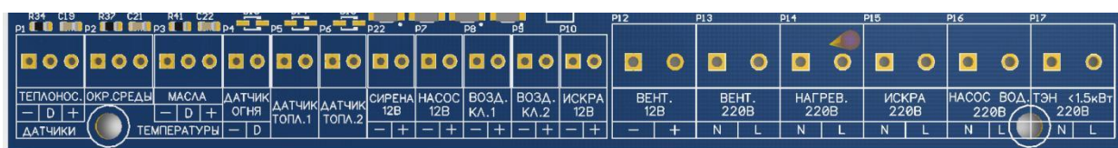
Рисунок 13 – Фрагмент управляющей платы с обозначениями
