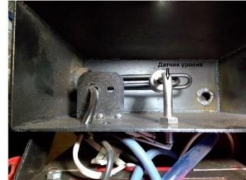
Рисунок 6. Датчик уровня горелки
