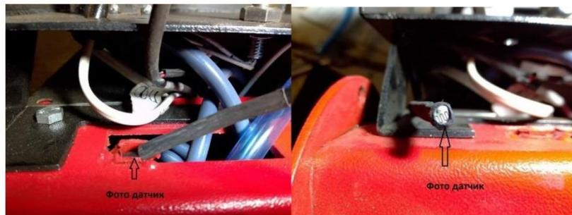
Рисунок 5. Датчик света горелки
