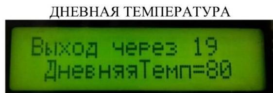
Назначение функции: установка дневной температуры теплоносителя.
