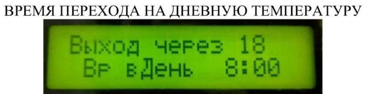
Назначение функции: установка времени перехода на заданную дневную температуру.
