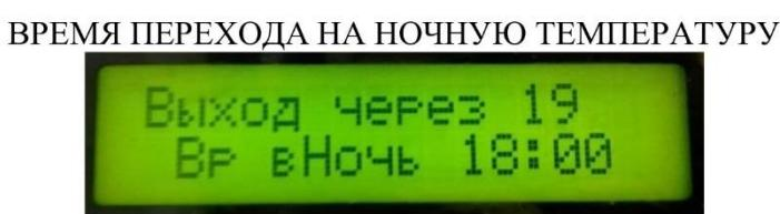
Назначение функции: установка времени перехода на заданную ночную температуру.
