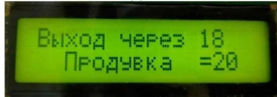
Назначение функции: управление вентилятором надува (далее ВН) при поджоге горелки (значения показателей указаны в таблице 1).
