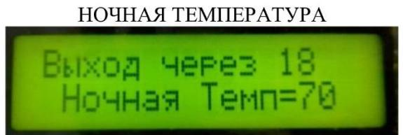
Назначение функции: установка ночной температуры теплоносителя.
