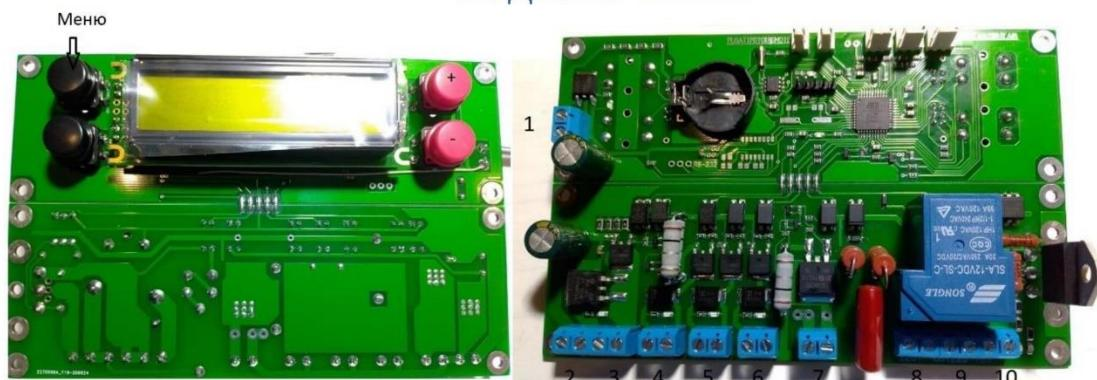
Рисунок 3. Плата блока управления горелкой
