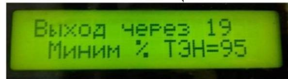
Назначение функции: поддержание температуры при работе горелки.
